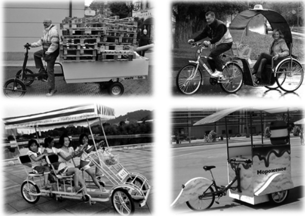
Рисунок 5.4.1 – Велосипед различного функционального назначения
