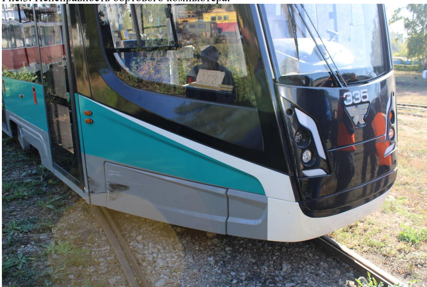
Рис. 4. Повреждение кузова после ДТП.
