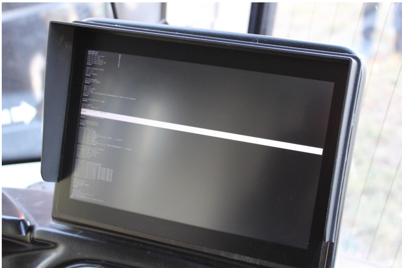
Рис.3. Неисправность бортового компьютера.
