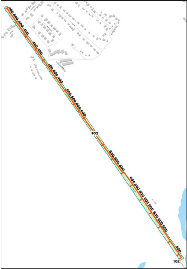
Рисунок 101 – Технологическая зона № 102 Технологическая зона № 103 Сеть ливневой канализации проложена по ул. Виктора Музыки и ул. Михаила Трунова с последующим выпуском на рельеф. Общая протяженность сети технологической зоны № 103 согласно данным электронной модели, составляет 644 м. Диаметр трубопроводов различный от 300 до 400 мм. Площадь территории, покрываемой сетями технологической зоной № 103 составляет 3,35 Га. Технологическая зона представлена на рисунке 101.
