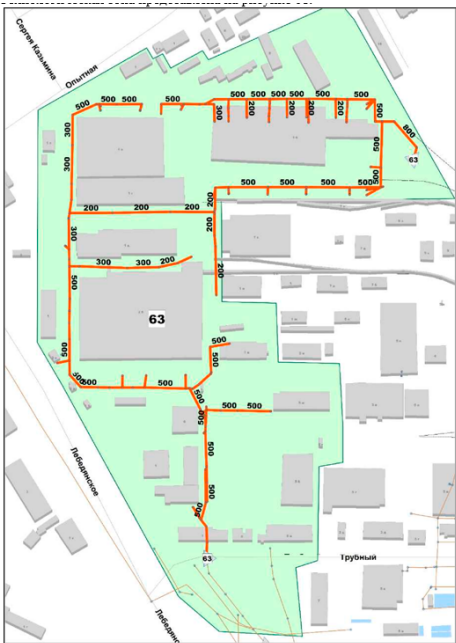
Рисунок 62 – Технологическая зона № 63 Технологическая зона № 64 Сеть ливневой канализации проложена на территории промплощадки Липецкого трубного завода в районе Лебедянского шоссе с последующим выпуском в пруд. Общая протяженность сети технологической зоны № 64, согласно данным электронной модели, составляет 837 м. Диаметр трубопроводов различный от 100 до 1000 мм. Площадь территории, покрываемой сетями технологической зоной № 64 составляет 5,2 Га. Технологическая зона представлена на рисунке 62.
