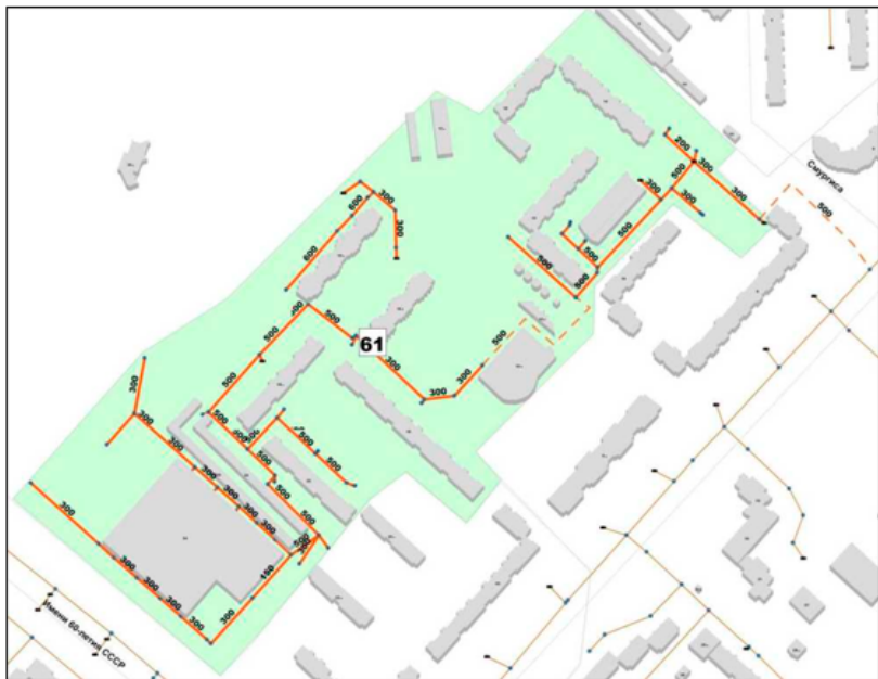
Рисунок 60 – Технологическая зона № 61 Технологическая зона № 62 Сеть ливневой канализации проложена на территории промплощадки в районе пересечения ул. Белана и Воронежского шоссе с последующим выпуском на рельеф. Общая протяженность сети технологической зоны № 62, согласно данным электронной модели, составляет 1 018 м. Диаметр трубопроводов различный от 150 до 450 мм. Площадь территории, покрываемой сетями технологической зоной № 62 составляет 3,74 Га. Технологическая зона представлена на рисунке 60.
