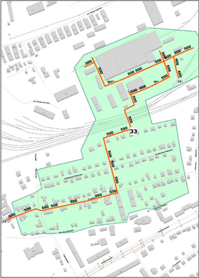
Рисунок 33 – Технологическая зона № 33 Технологическая зона № 34 Технологическая зона находится в Центральном районе. Сеть ливневой канализации проложена по ул. 8 марта от дома № 17 до дома № 20а по ул. Ворошилова с последующим выпуском в р. Липовку. Общая протяженность сети технологической зоны № 34, согласно данным электронной модели, составляет 2 208,24 м. Диаметр трубопроводов различный от 100 до 600 мм. Площадь территории, покрываемой сетями технологической зоной № 34 составляет 32,23 Га. Технологическая зона представлена на рисунке 33.
