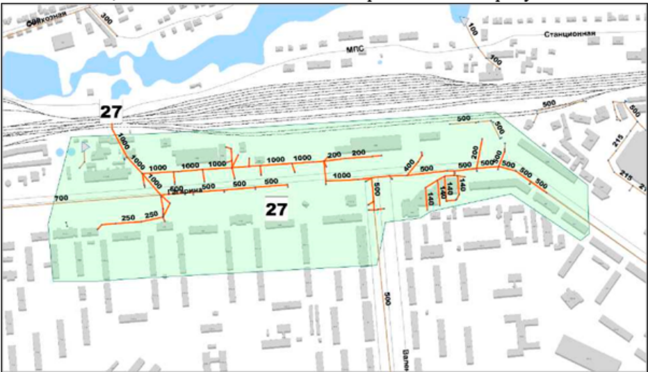
Рисунок 27 – Технологическая зона № 27 Технологическая зона № 28 Технологическая зона находится в Центральном районе. Сеть ливневой канализации проложена по ул. Гагарина от дома № 25 до дома № 8, по ул. Ленина от дома № 5 до перекрестка с ул. Гагарина, по ул. Плеханова от перекрестка с ул. Пролетарской до перекрестка с ул. Гагарина, по ул. Интернациональной от перекрестка с ул. Пролетарской до перекрестка с ул. Гагарина, с последующим выпуском в Студеный ручей в районе дома № 8 по ул. Ленина. Общая протяженность сети технологической зоны № 28, согласно данным электронной модели, составляет 5 042 м. Диаметр трубопроводов различный от 100 до 1200 мм. Площадь территории, покрываемой сетями технологической зоной № 28 составляет 67,52 Га. Технологическая зона представлена на рисунке 27.
