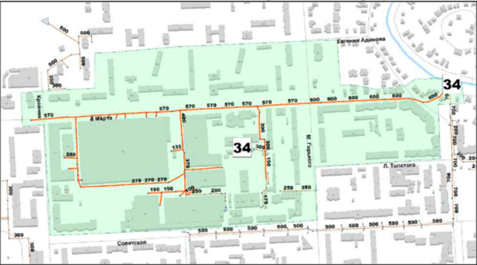
Рисунок 33 – Технологическая зона № 33 Технологическая зона № 34 Технологическая зона находится в Центральном районе. Сеть ливневой канализации проложена по ул. 8 марта от дома № 17 до дома № 20а по ул. Ворошилова с последующим выпуском в р. Липовку. Общая протяженность сети технологической зоны № 34, согласно данным электронной модели, составляет 2 208,24 м. Диаметр трубопроводов различный от 100 до 600 мм. Площадь территории, покрываемой сетями технологической зоной № 34 составляет 32,23 Га. Технологическая зона представлена на рисунке 33.
