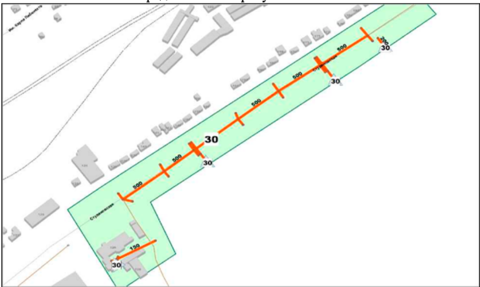
Рисунок 30 – Технологическая зона № 30 Технологическая зона № 31 Технологическая зона находится в микрорайоне «Свободный Сокол». Сеть ливневой канализации проложена: от дома № 134 до дома №16 по ул. Студеновской с последующим выпуском в кювет; от дома № 2 по ул. В. П. Газина с выпуском в Студеный ручей в районе дома № 3. Общая протяженность сети технологической зоны № 31, согласно данным электронной модели, составляет 847 м. Диаметр трубопроводов различный от 135 до 400 мм. Площадь территории, покрываемой сетями технологической зоной № 31 составляет 7,8 Га. Технологическая зона представлена на рисунке 30.
