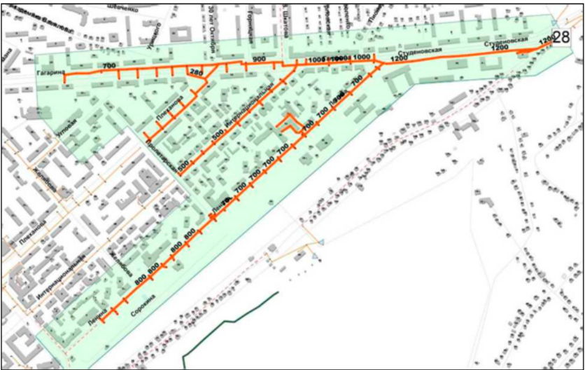
Рисунок 27 – Технологическая зона № 27 Технологическая зона № 28 Технологическая зона находится в Центральном районе. Сеть ливневой канализации проложена по ул. Гагарина от дома № 25 до дома № 8, по ул. Ленина от дома № 5 до перекрестка с ул. Гагарина, по ул. Плеханова от перекрестка с ул. Пролетарской до перекрестка с ул. Гагарина, по ул. Интернациональной от перекрестка с ул. Пролетарской до перекрестка с ул. Гагарина, с последующим выпуском в Студеный ручей в районе дома № 8 по ул. Ленина. Общая протяженность сети технологической зоны № 28, согласно данным электронной модели, составляет 5 042 м. Диаметр трубопроводов различный от 100 до 1200 мм. Площадь территории, покрываемой сетями технологической зоной № 28 составляет 67,52 Га. Технологическая зона представлена на рисунке 27.
