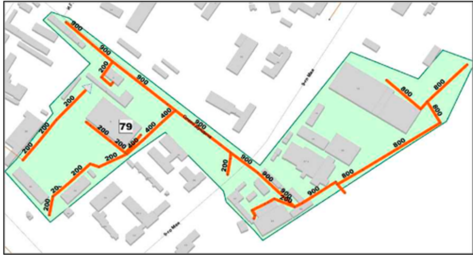
Рисунок 78 – Технологическая зона № 79 Технологическая зона № 80 Сеть ливневой канализации проложена на территории Липецкого Metallургического комбината «НЛМК» по ул. Бестужева с последующим выпуском на рельеф. Общая протяженность сети технологической зоны № 80, согласно данным электронной модели, составляет 911 м. Диаметр трубопроводов различный от 100 до 500 мм. Площадь территории, покрываемой сетями технологической зоной № 80 составляет 4,6 Га. Технологическая зона представлена на рисунке 78.
