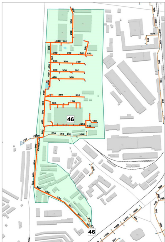
Рисунок 44 – Технологическая зона № 45 Технологическая зона № 46 Технологическая зона находится в районе Трубного завода. Сеть ливневой канализации проложена по Северному проезду от дома № 11 до выпуска в районе дома № 16а по ул. Московской. Общая протяженность сети технологической зоны № 46, согласно данным электронной модели, составляет 3 005 м. Диаметр трубопроводов различный от 150 до 600 мм. Площадь территории, покрываемой сетями технологической зоной № 46 составляет 23,81 Га. Технологическая зона представлена на рисунке 44.
