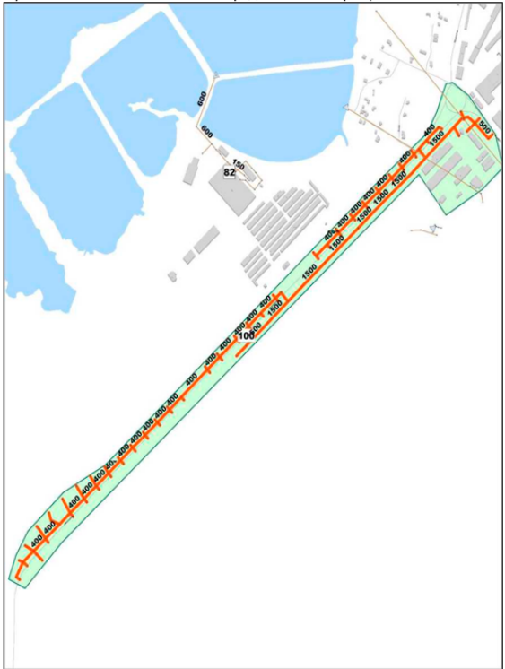
Рисунок 99 – Технологическая зона № 100 Технологическая зона № 101 Сеть ливневой канализации проложена на территории промплощадки завода ЖБИ № 2. Общая протяженность сети технологической зоны № 101 согласно данным электронной модели, составляет 433 м. Диаметр трубопроводов различный от 100 до 300 мм. Площадь территории, покрываемой сетями технологической зоной № 101 составляет 1,8 Га. Технологическая зона представлена на рисунке 99.
