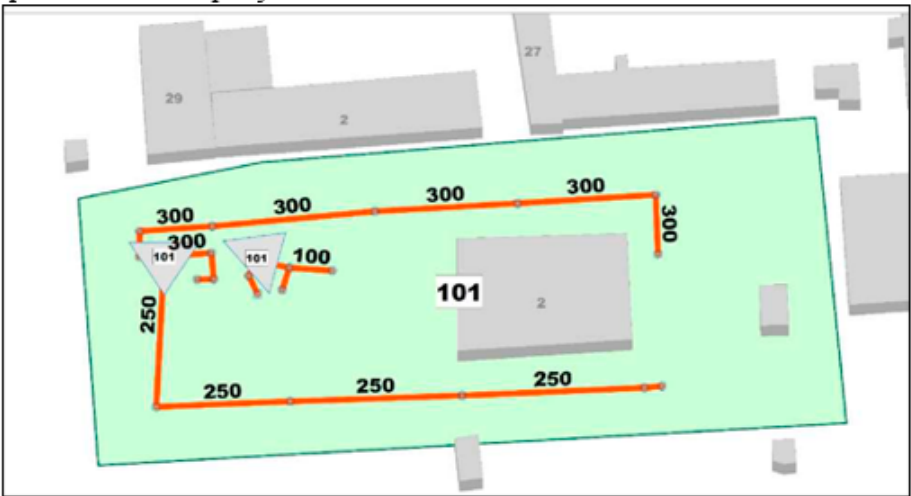
Рисунок 100 – Технологическая зона № 101 Технологическая зона № 102 Сеть ливневой канализации проложена по Октябрьскому мосту с последующим выпуском на рельеф. Общая протяженность сети технологической зоны № 102 согласно данным электронной модели, составляет 2 176 м. Диаметр трубопроводов различный от 200 до 600 мм. Площадь территории, покрываемой сетями технологической зоной № 102 составляет 6,8 Га. Технологическая зона представлена на рисунке 100.
