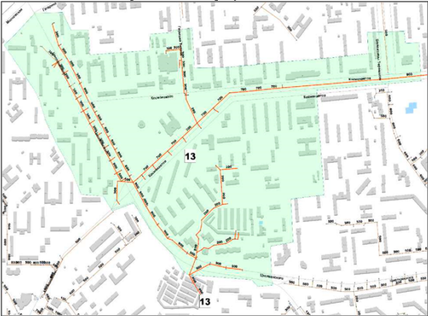
Рисунок 14 – Технологическая зона № 13 Технологическая зона № 14 Технологическая зона находится в микрорайонах № 9, №8, районе «ул. Бескрайней». Сеть ливневой канализации проложена по: ул. Филиппенко от дома № 11/2 по ул. Космонавтов до дома № 7 по ул. Филиппенко; по ул. Московской от дома № 45а до дома № 9, по ул. Загородной от дома № 20 до ул. Космонавтов, по ул. Авиационной от дома № 32 до ул. Космонавтов, по ул. Космонавтов от дома № 110 до дома № 39, сеть проложена через гаражный кооператив «Мехземстрой» вдоль забора туберкулезного диспансера с последующим выпуском в Каменный Лог. Общая протяженность сети технологической зоны № 14, согласно данным электронной модели, составляет 9 373 м. Диаметр трубопроводов различный от 150 до 1600 мм. Площадь территории, покрываемой сетями технологической зоной № 14 составляет 107,7 Га. Технологическая зона представлена на рисунке 14.
