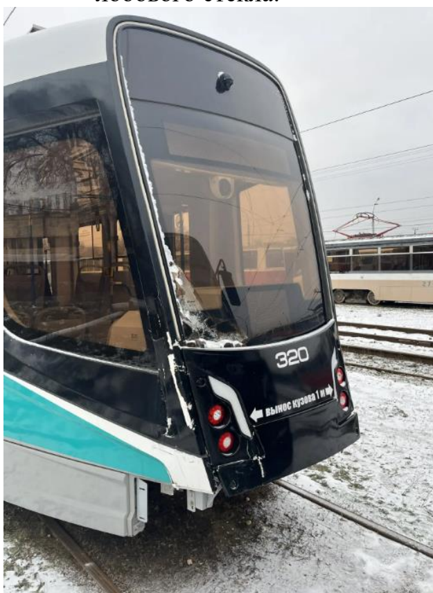
Рис. 5. Трамвайный вагон бортовой номер 320. Повреждение кузова и заднего стекла салона.
