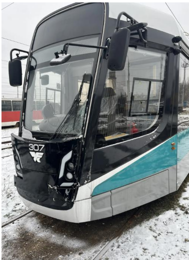
Рис. 4. Трамвайный вагон бортовой номер 307. Повреждение кузова и лобового стекла.
