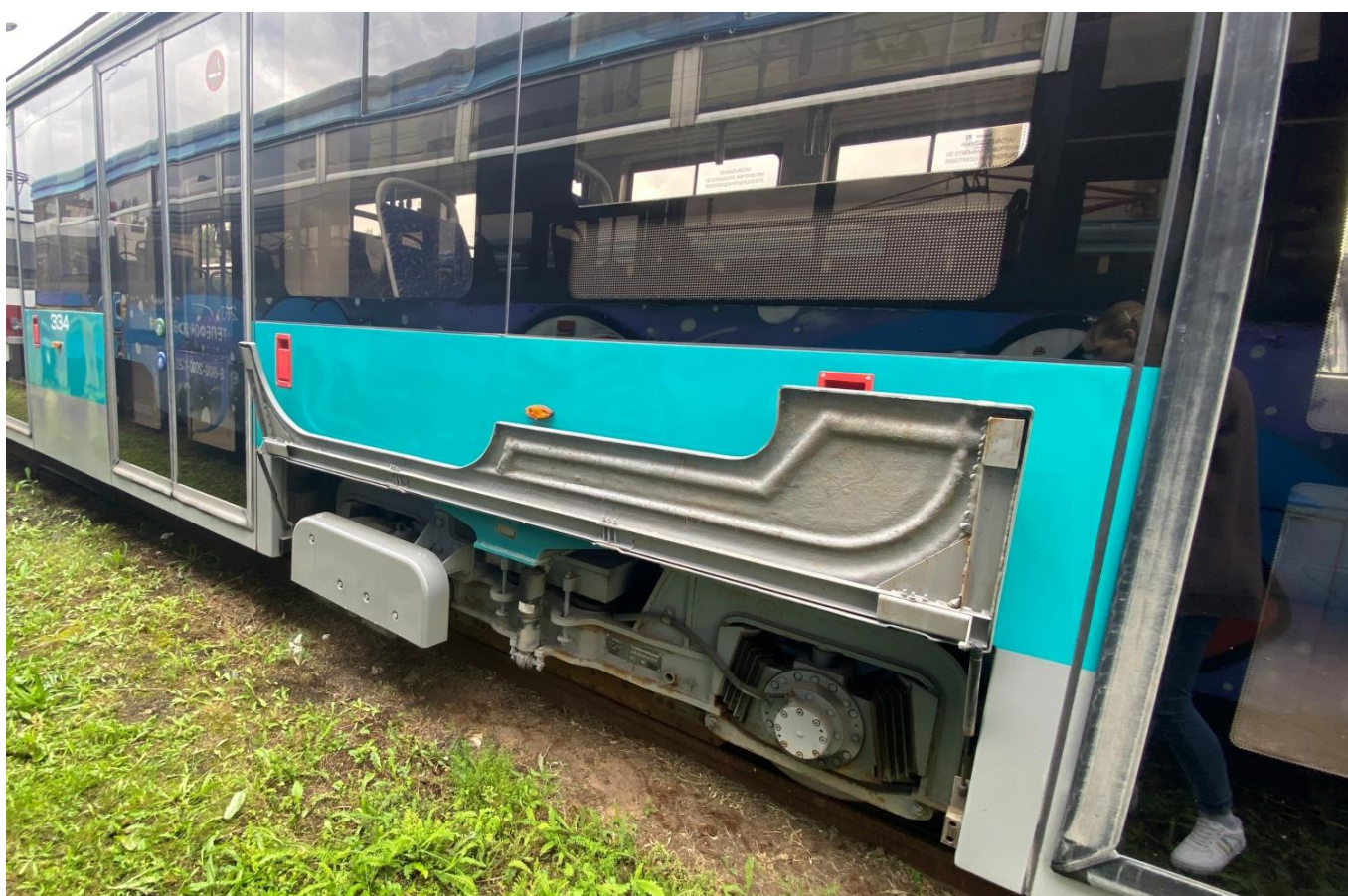
Рис. 9. Вагон № 334 – коррозия моторной тележки
