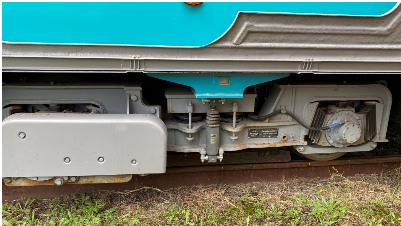
Рис. 8. Вагон № 326 – коррозия моторной тележки
