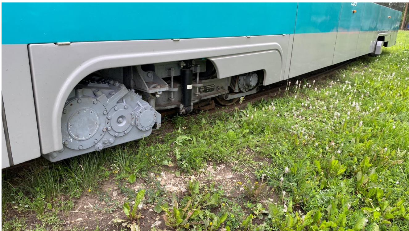
Рис. 4. Вагон № 336 – посторонний шум в редукторе 1-ой колесной пары
