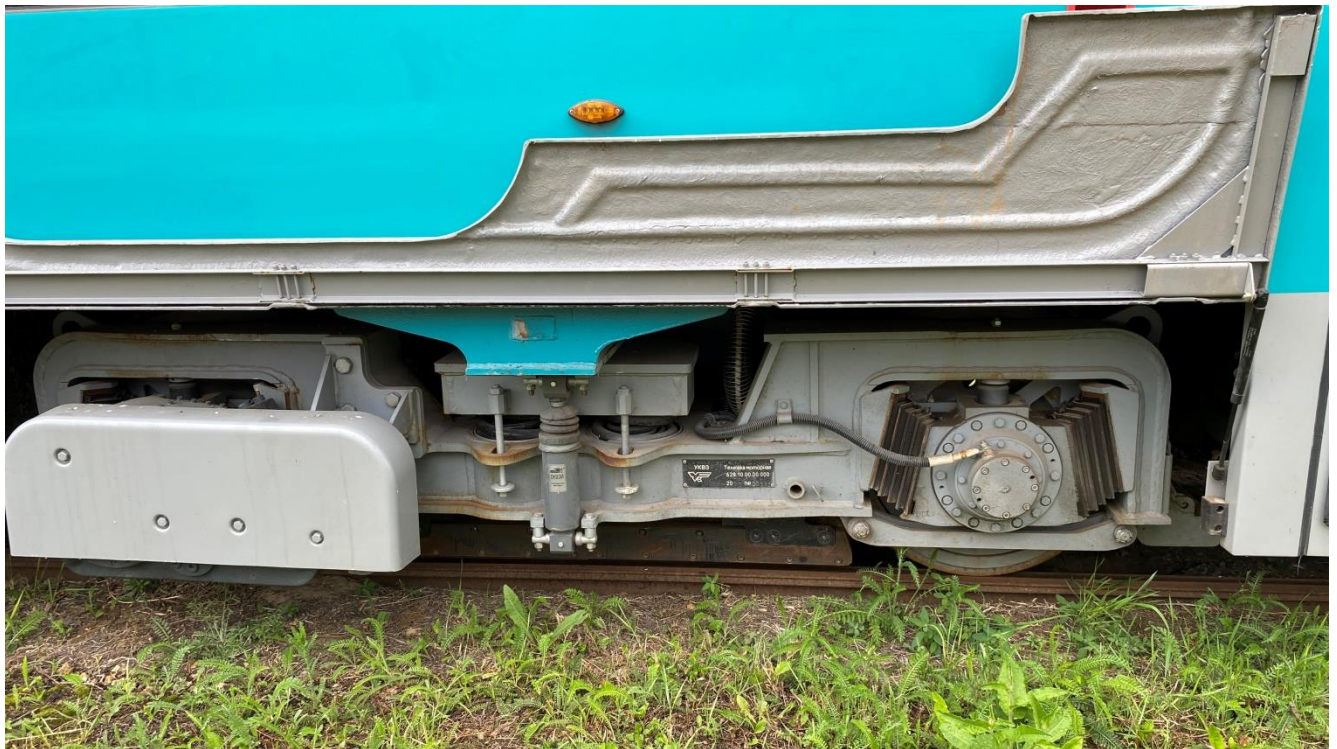
Рис. 13. Вагон № 320 – коррозия моторной тележки
