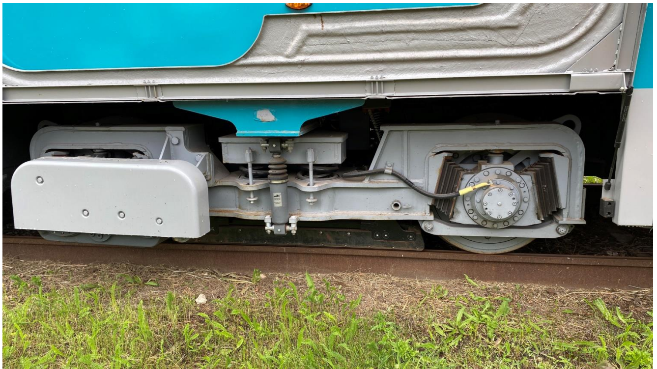
Рис. 12. Вагон № 314 – коррозия моторной тележки
