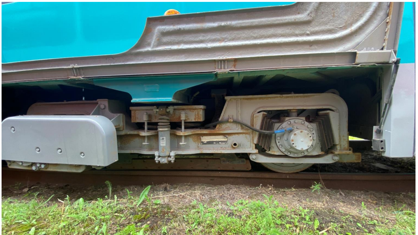
Рис. 10. Вагон № 325 – коррозия моторной тележки
