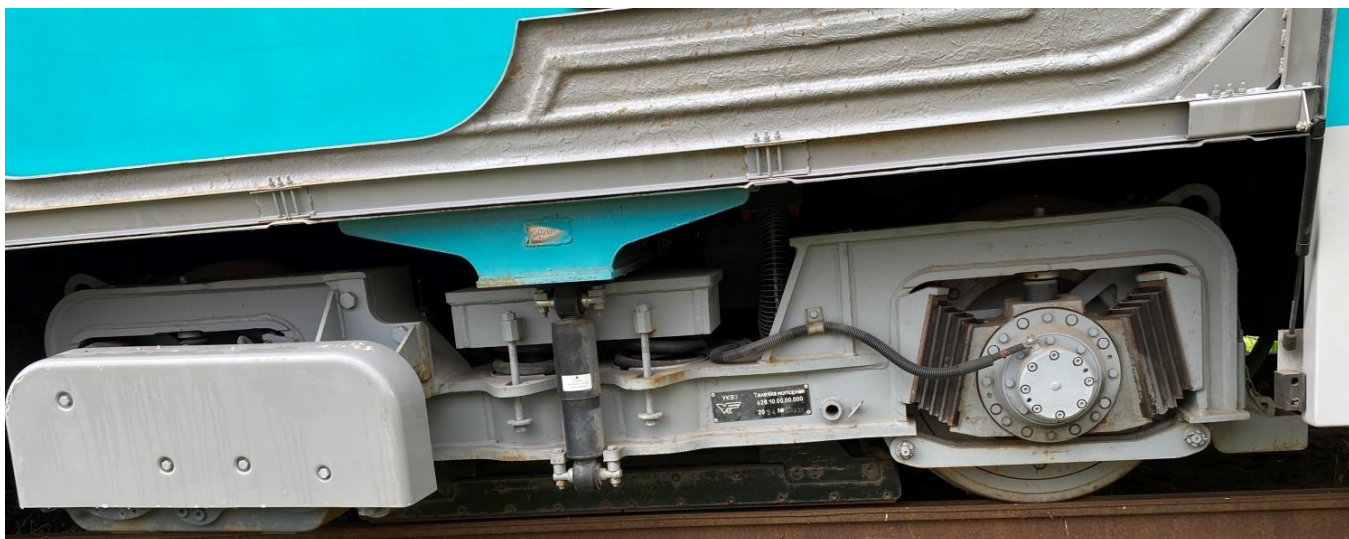
Рис. 14. Вагон № 331 – коррозия моторной тележки
