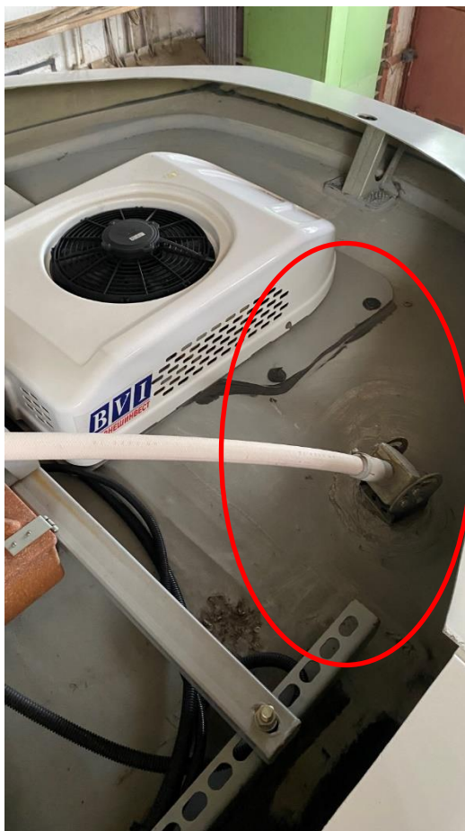
Рис. 7. Вагон № 308 – отсутствует антенна GPS
