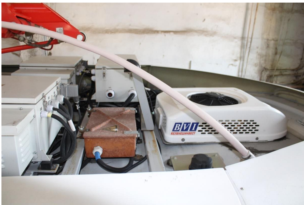
Рис. 9. Часть механизма подъёма токоприемника трамвайного вагона
