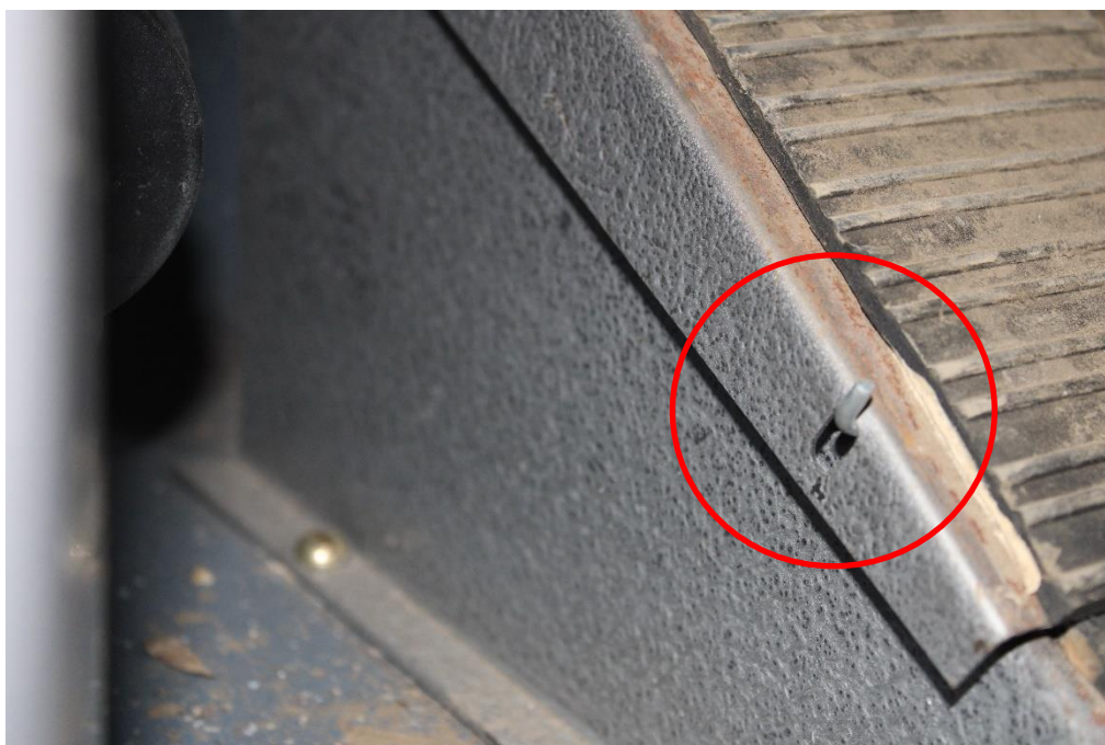
Рис. 12. Крепеж крышки педали безопасности трамвайного вагона
