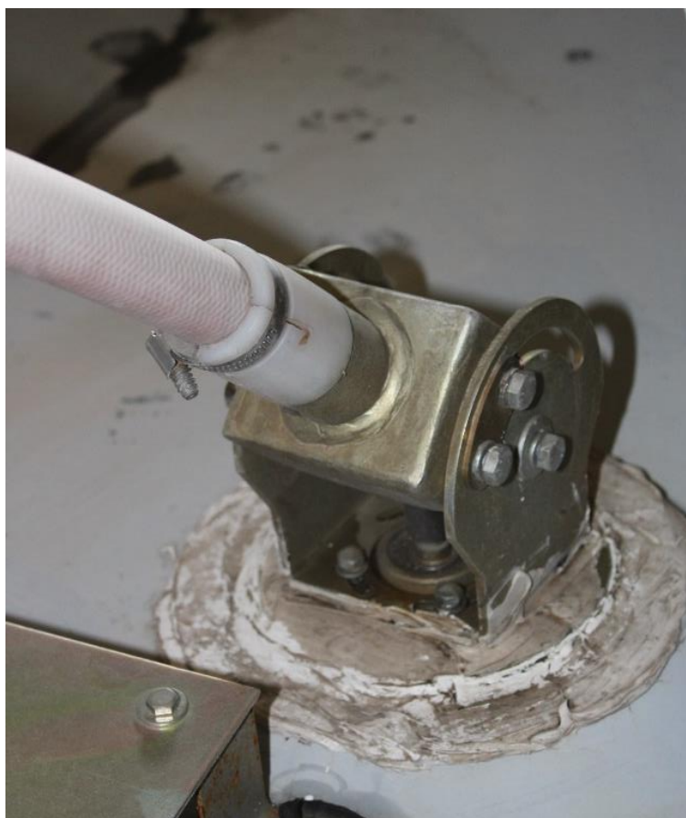
Рис. 10. Часть механизма подъёма токоприемника, перестающая нормально функционировать при образовании на ней естественной наледи
