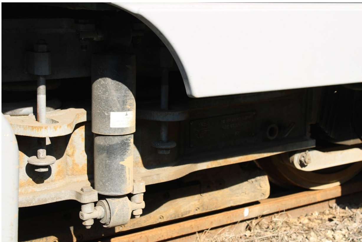
Рис. 13. Коррозия первой моторной тележки трамвайного вагона КТМ 71-628-02 бортовой номер 316
