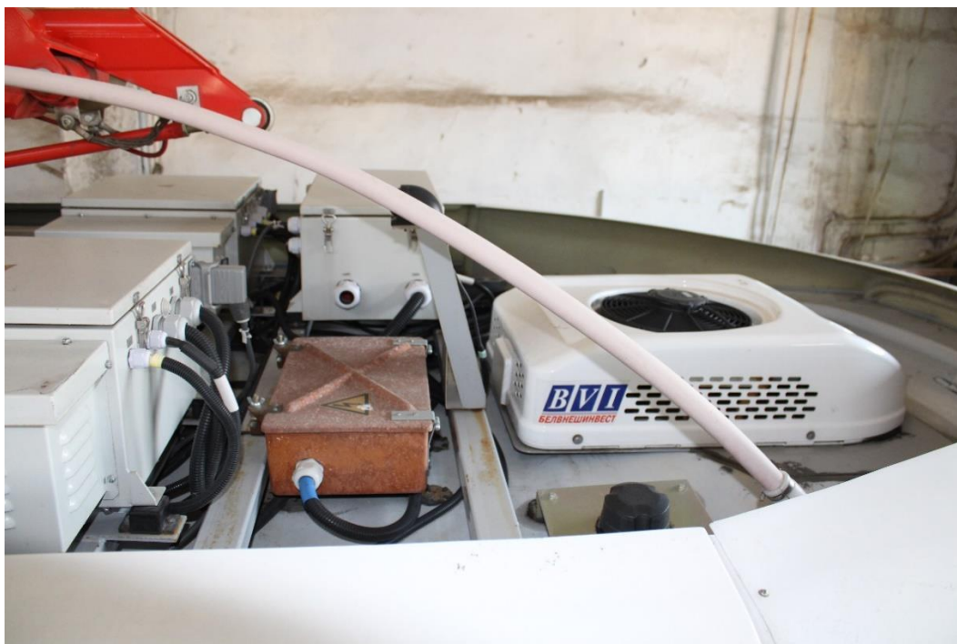
Рис. 8. Часть механизма подъёма токоприемника трамвайного вагона
