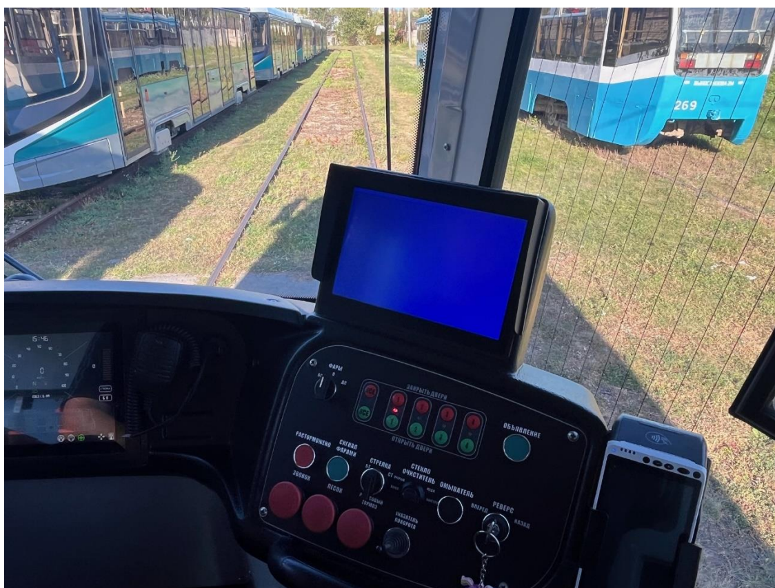
Рис. 2. Не работает бортовой компьютер вагонов № 332, № 335 на момент проведения Проверки.
