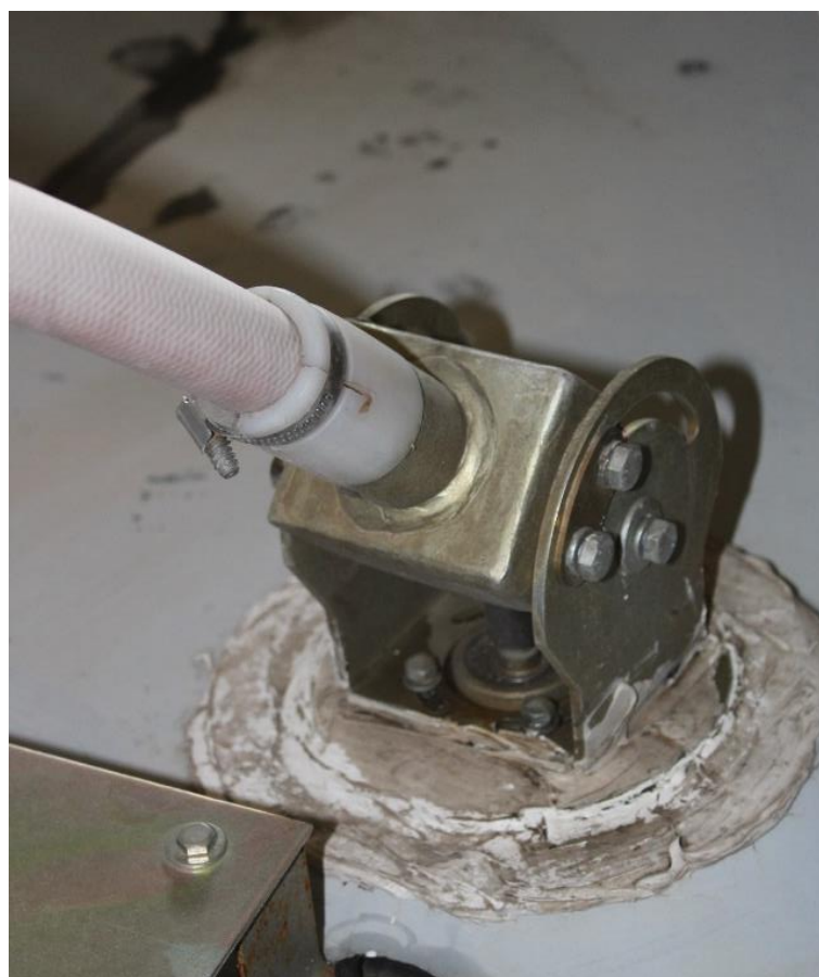
Рис. 9. Часть механизма подъёма токоприемника, перестающая нормально функционировать при образовании на ней естественной наледи
